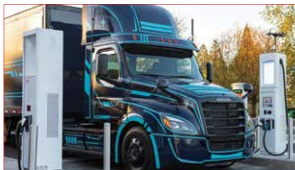
DTNA работает не только над внедрением в производство новых электрических коммерческих автомобилей, но также занимается и обустройством инфраструктуры для их обслуживания. На станции, открытой совместно с PGE, могут одновременно заряжаться до восьми транспортных средств – от развозных фургонов и автобусов до магистральных тягачей. В будущем мощность зарядных устройств поднимут до 1 мегаватта, что вчетверо превышает ныне существующие.
