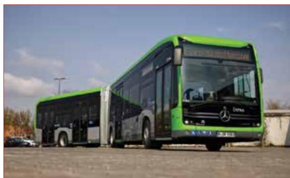
Автопарк транспортного оператора Ганновера пополнили две модели, оснащенные аккумуляторами второго поколения, которые на треть более емкие, чем их предшественники. В данном случае на автобусах батареи установлены в десяти модулях, суммарная емкость которых 330 кВт·ч. Это позволило увеличить интервалы между зарядками, которые осуществляются с помощью установленного на крыше пантографа.
