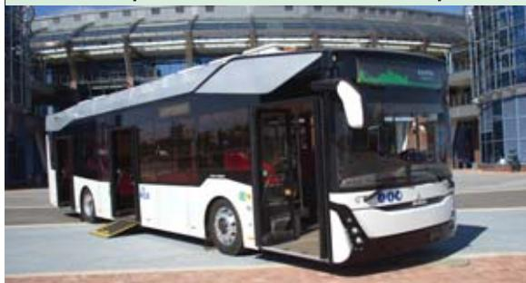
Внешне автобус походит на «междугородник» и, по задумке дизайнеров, благодаря горбинке на крыше должен напоминать силуэт зубра. Площадь панорамного остекления увеличилась почти на треть. Каркас изготовлен из труб стойкой к коррозии стали со спецпрофилем для большей несущей способности. Панели из алюминия и пластика также неприхотливы, что позволит избежать серьезного ремонта. Силовая установка размещена над ними, чтобы свести к минимуму шумы и вибрации, сообщает пресс-служба предприятия.
