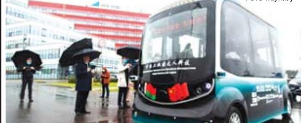
Электробус разработан по технологии ученых из Сингапура. Максимальная скорость, которую может развить прототип, составляет 40 км/ч. Правда, безопасная эксплуатационная скорость ниже – около 25 км/ч. Запас хода – порядка 180 км. Полная зарядка занимает не более 4 часов.
