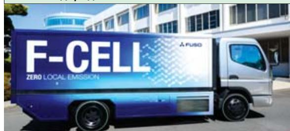
В первую очередь с конвейера начнет сходить серийная версия легкого грузовика eCanter F-Cell. Mitsubishi Fuso Truck and Bus представил концепт грузовика на Токийском автосалоне 2019 года. Модель eCanter F-Cell на водородных топливных элементах способна проехать до 300 км. Заправка занимает около 10 минут.
