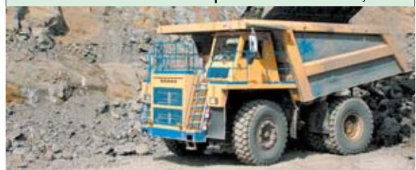
Машины предназначены для перевозки известняка в карьере острова Себу и специально модифицированы в соответствии с пожеланиями потребителя и климатическими условиями эксплуатации. Карьерные самосвалы выполнены в тропическом исполнении и отличаются увеличенным объемом кузова, многодисковыми маслоохладждающими тормозами и дополнительными топливными фильтрами.
