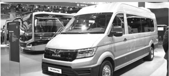
Он имеет длину 7391 мм, ширину 2089 мм и высоту 2695 мм. В салоне размещаются 15 комфортабельных кресел для пассажиров. В движение машину приводит 2,0-литровый дизельный турбодвигатель, развивающий мощность 177 л. с. и максимальный крутящий момент 410 Нм. Коробка передач – механическая, 6-ступенчатая. Привод осуществляется на задние колеса.
