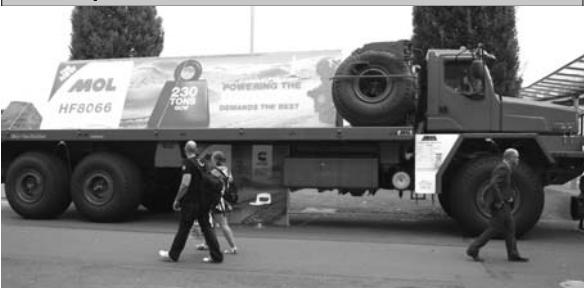
Внедорожный грузовик MOL HF8066 (6x6) поражает своими размерами: его длина – 14 м, ширина – 3,9 м, высота – 4,1 м. Грузовая платформа имеет длину 9,15 м. Колесная база равна 9,8 м. Модель оснащена тремя ведущими мостами Kessler – передним на 20 т и двумя задними 2x30 т. Полная масса грузовика 80 т. Тягач может работать в составе автопоезда общим весом 230 тонн.
