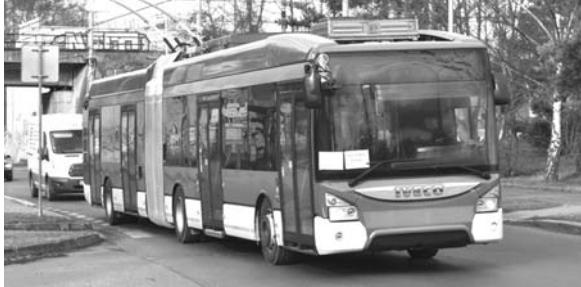
Шасси новинки изготовлено на заводе IVECO во Франции, а вся электрическая начинка – производства Skoda Electric. Модель называется 35 Tr 18 m. Она оснащена кузовом от известного городского низкопольного автобуса Iveco's Urbanway.
