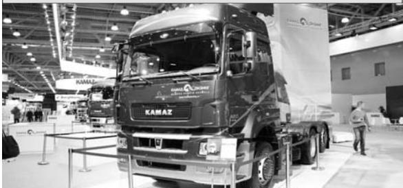
Главная особенность новинки, имеющей колесную формулу 6x2-2, – наличие задней подъемной оси с автоматическим управлением, которая позволяет экономить топливо при езде без груза или без полуприцепа.
