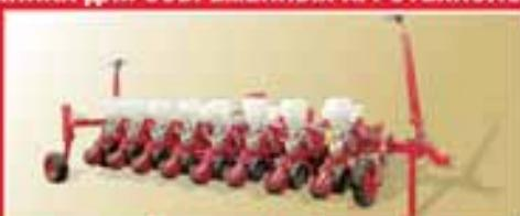
Сеялка пневматическая 8-ми рядная Вега 8 для точного высева семян пропашных культур по минимальной (Min-Nill) и традиционной агротехнологии.
