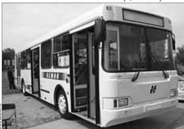
тель мощностью 177 л. с., что позволяет максимально разогнать машину до 90 км/ч. В комплекте с силовым агрегатом, который соответствует международным экологическим стандартам Euro-4, работает 6-ступенчатая механическая коробка передач 6S-400. «Неман» всерьез взялся за освоение рынка автобусов малого класса. На подходе еще один опытный образец из
