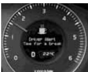
Система предназначена следить за физическим состоянием водителя. Электроника анализирует поведение автомобиля, рассчитывает время нахождения в дороге и другие показатели. Как только компьютер решает, что водитель устал, то на приборной панели появляется значок в виде чашечки кофе – это говорит о том, что человеку надо сделать перерыв и отдохнуть.
