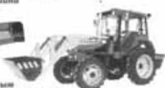
Трактор с фронтальными гидравлическими погрузчиками
