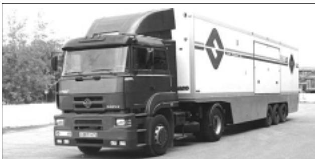
Седельный тягач «Урал-63674» предназначен для буксировки полуприцепов массой до 34,5 тонн. Он оснащен двигателем ЯМЗ-7601 («Евро-2», 300 л.с.) и коробкой передач производства ЯМЗ-239 ОАО «Автодизель» (Ярославль, «Группа ГАЗ»).
