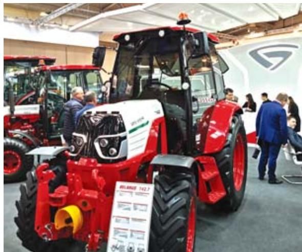
Опытный образец BELARUS-742 – новинка с корнями МТЗ-50 и МТЗ-80. Трактор станет базовым в новой линейке техники с двигателями мощностью 50–75 л. с. Модель отвечает европейским экологическим требованиям Stage V.
