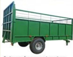
**Особенности:** Гидравлический задний трап. Грузоподъемность - 5 тонн
