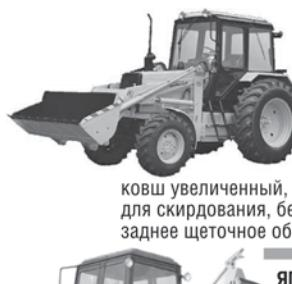
ковш увеличенный, бульдозерный отвал, приспособление для скирдования, бетоносмеситель навесной, заднее щеточное оборудование.
