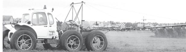
Отличительные особенности: низкое удельное давление на грунт – не более 0,15 кг/см кв., возможность работы на ранних стадиях роста с/х культур без их повреждения в колее колес при рабочих проходах, более раннее начало полевых работ – 25 дней, высокие рабочие скорости – 35 км/час, высокая расчетная производительность – 300 га/см, низкий расход топлива – 15 л/100 га
