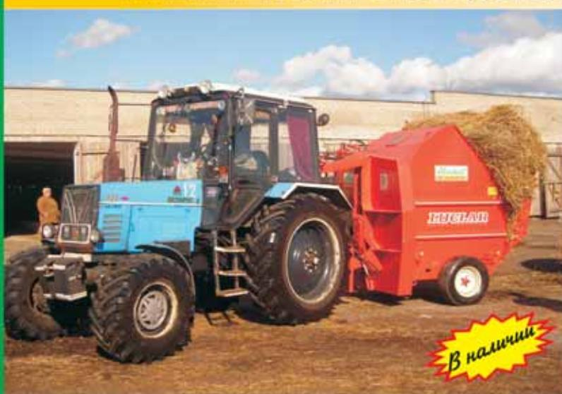
Измельчитель рулонов UNIBALL-1800 - это машина, предназначенная для измельчения и подачи в желоба сена и силоса, спрессованных в цилиндрические рулоны, а также для подстилки соломы.
