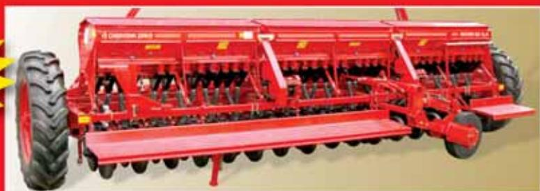
**АСТРА С3 5.4, АСТРА С3 5.4-04 и АСТРА С3 5.4-06** — сеялки предназначенные для рядового посева семян зерновых, зернобобовых культур с одновременным внесением минеральных удобрений. Могут быть использованы для посева семян других культур, близких к зерновым по размерам семян и нормам высева.
