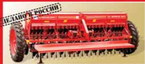
Сеялка АСТРА СЗ-3,6А предназначена для рядового посева семян зерновых культур, с одновременным внесением минеральных удобрений.
