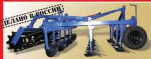
Культиватор навесной комбинированный КНК 6 для ресурсосберегающей основной обработки почвы, выполняющий за один проход рыхление и послойное крошение почвы, подрезание и измельчение сорной растительности и мульчирование остатками поверхности, выравнивание и уплотнение почвы.
