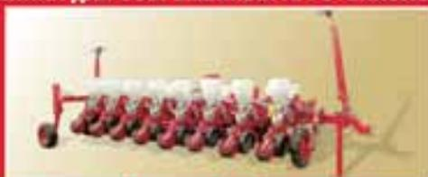
Сеялка пневматическая 8-ми рядная Vega-8 для точного высева семян пропашных культур по минимальной (Min-Nill) и традиционной агротехнологии.
