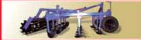
Культиватор кавесной комбинированный КНК-6 для ресурсосберегающей основной обработки почвы, выполняющий за один проход рыхление и пологое крошение почвы, подрезание и измельчение сорной растительности и мульчирование остатками поверхности, выравнивание и уплотнение почвы.
